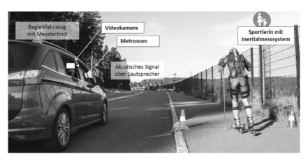
Abb. 2. Sportlerin mit Inertialmesssystem auf der Messstrecke begleitet von einem Fahrzeug
